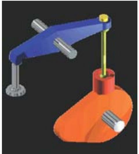
A rocker using a cam.
